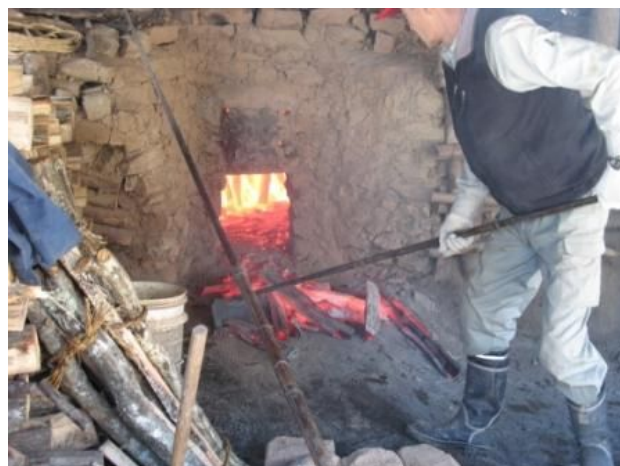
炭出し作業です
